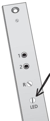
Če imajo vrata, v katera je vgrajen Inokey, tudi LED osvetlitev, lahko z gumbom za regulacijo občutljivosti fotosenzorja nastavljamo, ob kako močni svetlobi se bo LED osvetlitev na vratih vklopila.
